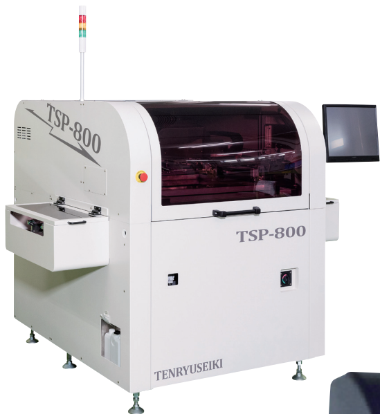
超高性能クリームハンダ印刷機 「TSP-800」
